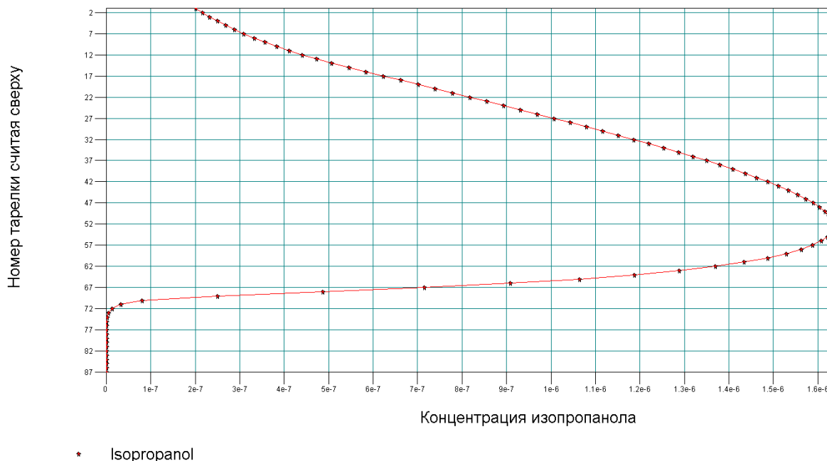
Концентрация изопропанола по тарелкам ректификационной колонны
